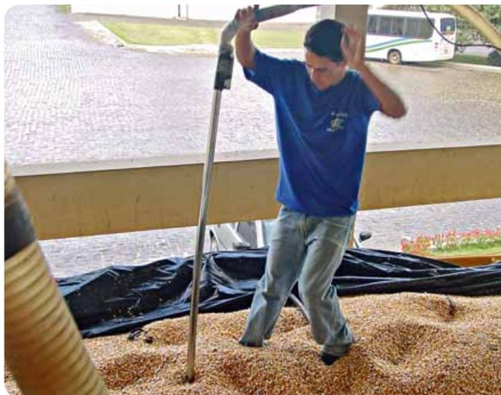
Foto 2 - Raccolta dei campioni incrementali con sonda, nel corso di un campionamento statico
