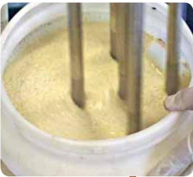
Foto 4 - Lo slurry, miscela di acqua e campione macinato, garantisce un elevato grado di omogeneità e minima probabilità di errore analitico
