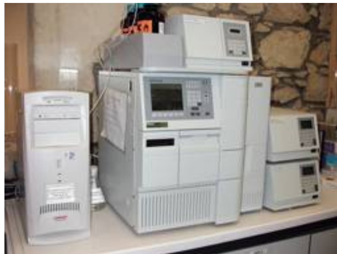
▲ Sistema HPLC per l'analisi di laboratorio delle micotossine su campioni di mais.
