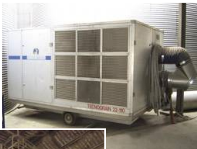
▲ Essiccatore (a sinistra) e refrigeratore (in alto) della Boretti sas.
